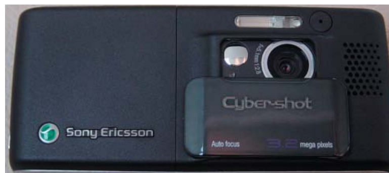
Endgültig vorbei sein soll das Mitnehmen einer „echten“ Digitalkamera. Das Cyber-Shot-Handy K800i weist sogar ein Xenon-Blitzlicht auf. Die 3,2-Megapixel-Kamera wird durch einen Schieber geschützt. Foto: JM
